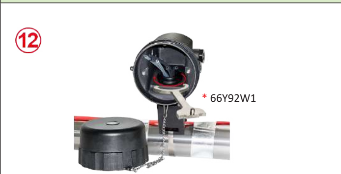
12 : Placer le joint dans le logement supérieur du pied, puis le boîtier au dessus. Orienter le boîtier selon la position souhaitée, puis placer et serrer l'écrou denté jusqu'au blocage.
